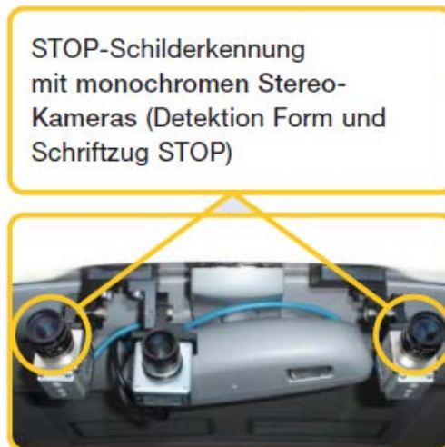
Abbildung 27: Stereokameras hinter der Frontscheibe (DaimlerChrysler AG, 2005)
