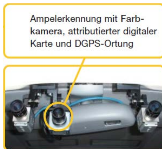
Abbildung 28: Farbkamera zur Ampelerkennung hinter der Frontscheibe (DaimlerChrysler AG, 2005)
