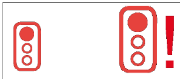
Abbildung 30: Informations- und Warnungssymbol im HUD des Rotlichtassistenten von INTERSAFE (Chen et al., 2007, S. 144)
