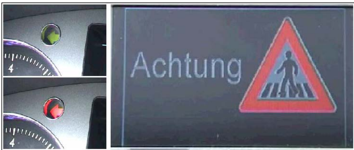
Abbildung 47: HMI der Linksabbiegeassistenten von VW, Änderung der Blinkerfarbe und Anzeige im Navigationsdisplay (Obojski & Meinecke, 2008, S. 9)
