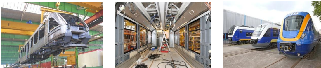
Abbildung 7.3: Rohbau, Innenausbau, Testing/Finish (v.li.), [11]
